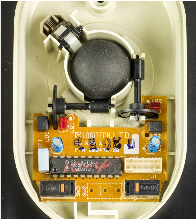
Vue de dessous d'une souris à boule, montrant le mécanisme de capture des mouvements
