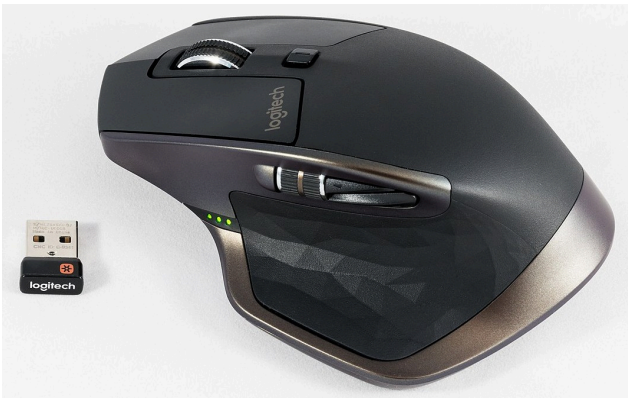
Souris sans fil, équipée de boutons supplémentaires, et représentée avec le récepteur à connecter à l'ordinateur
